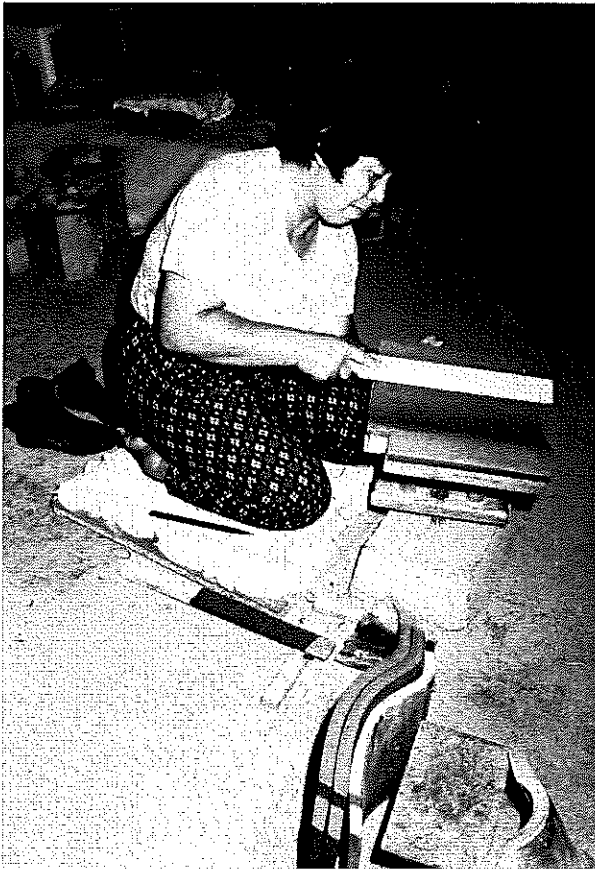
叩き板で棧瓦の荒地 あらじ を叩き締めているところ (写真：京都府立山城郷土資料館提供)
