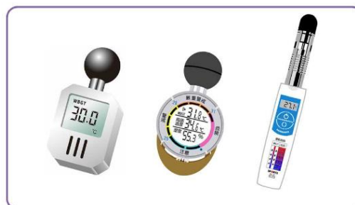
図 9 携帯型（ハンディタイプ）の電子式暑さ指数（WBGT）計
