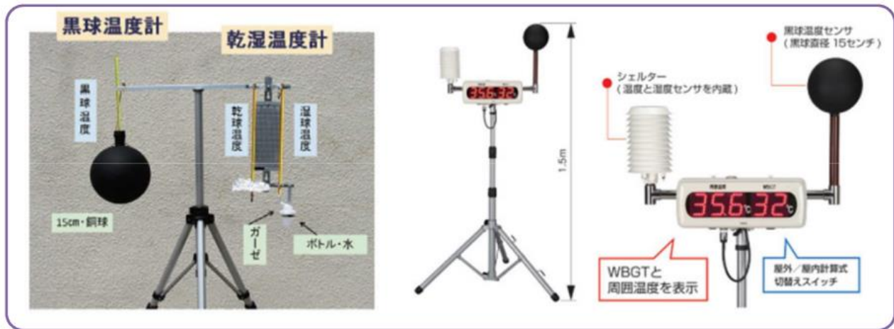
図 8 暑さ指数（WBGT）測定装置 左は基本型、右は電子式（環境省：熱中症熱中症環境保健マニュアル 2022）
