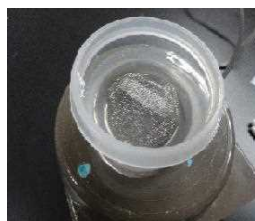
台所用金網を用いて、レーヨンを再生させる
