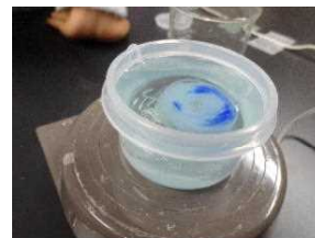
台所用金網を用いて、レーヨンを再生させる
