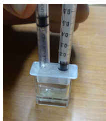
パッチテスト容器を用いて気体を発生させる
