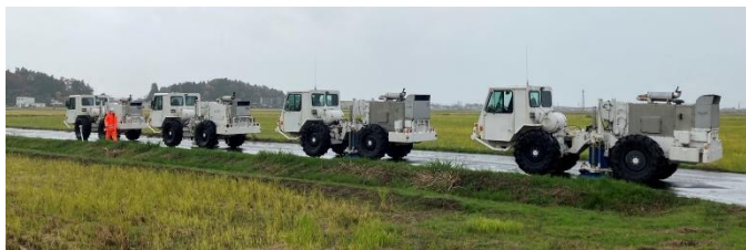
【弾性波探査の作業風景。大型の車を用いて地下に振動を送り、地表に跳ね返ってきた信号を観測して地下構造を推定する。】
