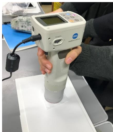
図5. 色彩色差計を用いた測定の様子
