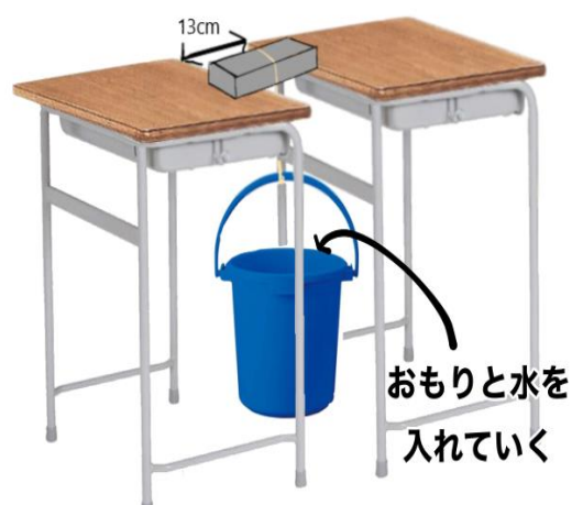
図 2. 強度の測定の仕方
