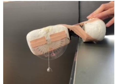
図 4. 足首の模型 (計測時) 分度器と糸で角度を測った。
