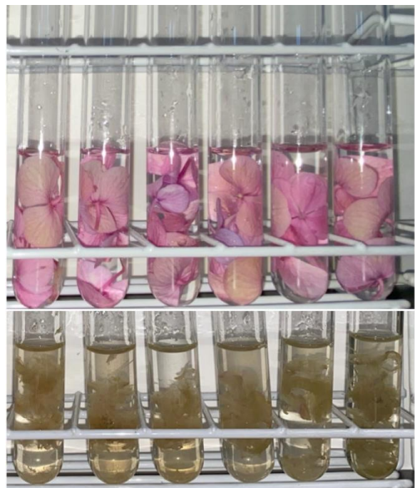
図 2. アジサイの花びらと硝酸アルミニウム水溶液の混合後の様子
