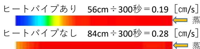
通気管表面の温度分布
