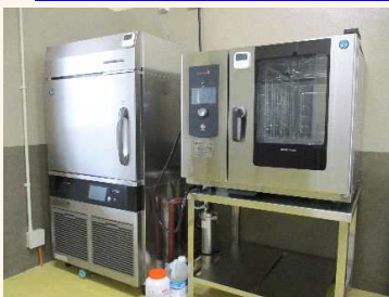
ブラストチラー(急速冷却機)(左) スチームコンベクションオーブン(右)
