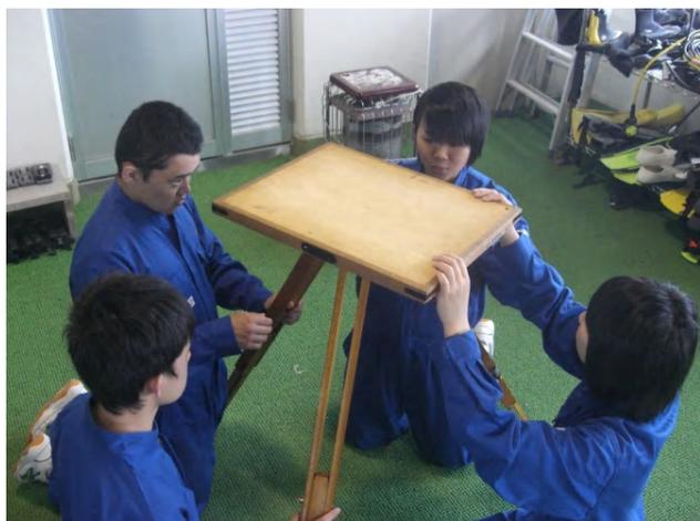
2日目 平板測量の据え付け作業。スピードと精度が求められる作業なので習得に時間がかかりました。
