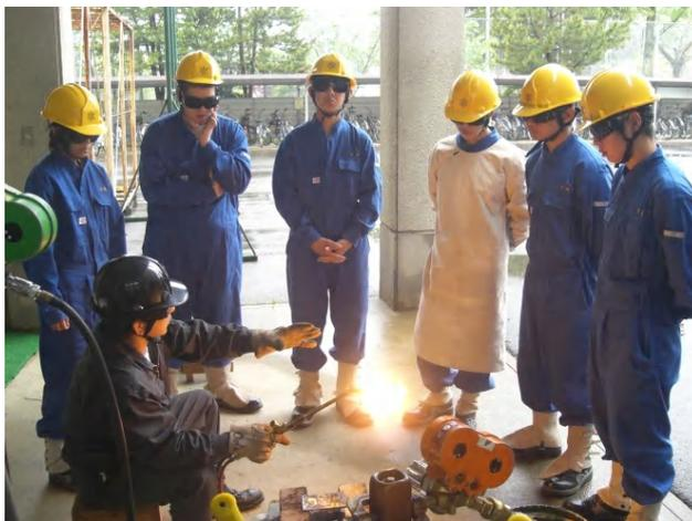
5日目 ガス溶接。アセチレンガスを用いての鉄板溶断作業。火炎の迫力に驚きました。
