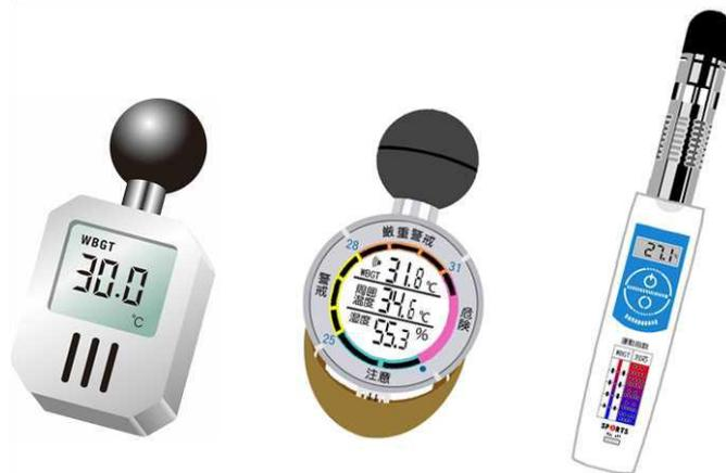
図8 携帯型（ハンディータイプ）の電子式暑さ指数（WBGT）計
