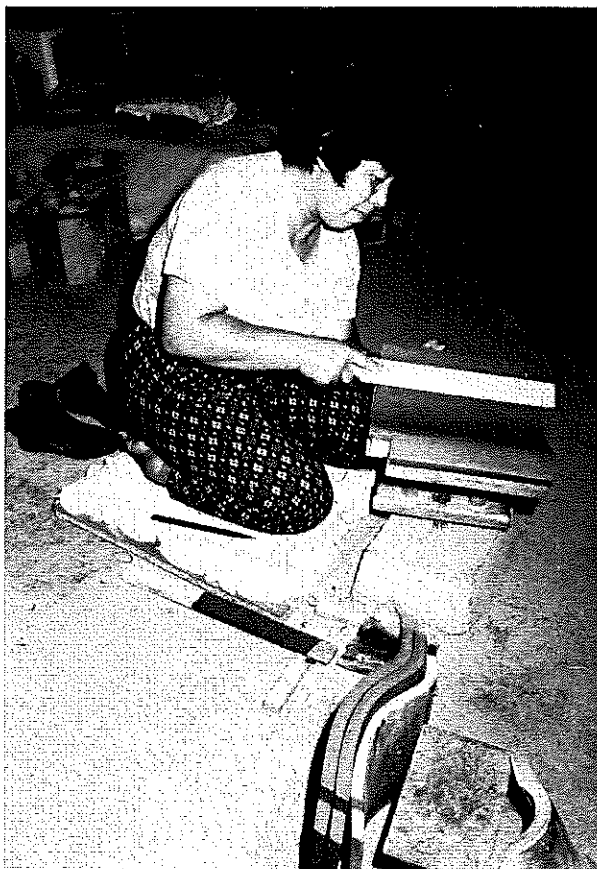
叩き板で棧瓦 あらじ の荒地を叩き締めているところ (写真：京都府立山城郷土資料館提供)
