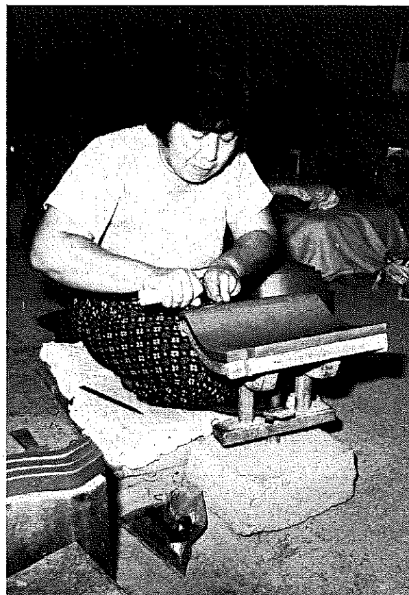
コテで棧瓦 しらじ の素地を磨いているところ (写真：京都府立山城郷土資料館提供)
