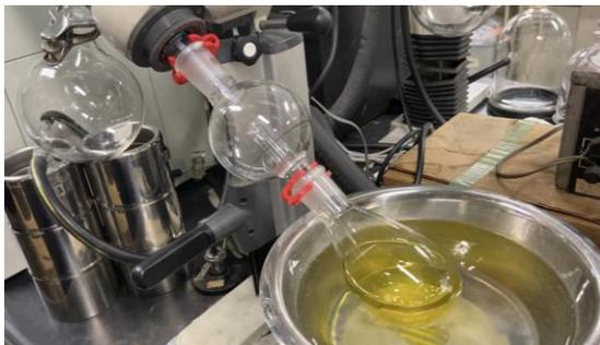
写真⑤ エバポレーターによる蒸発
