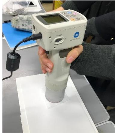
図5. 色彩色差計を用いた測定の様子
