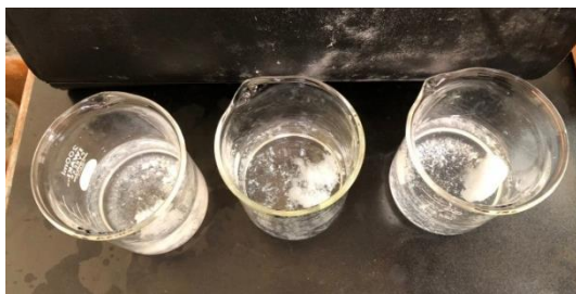
図 2. ゲル化の様子 (左から+, -, 電荷なし)
