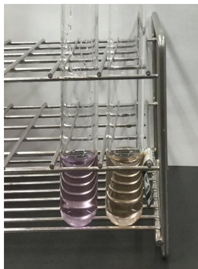
図 10. DPPH 法 反応後 (左から順にブランク試料, ローズマリー)
