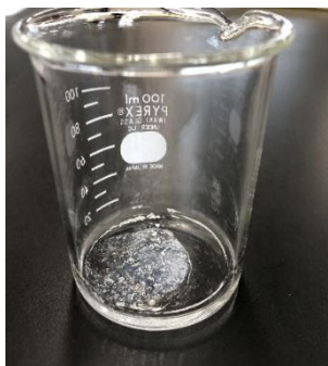
図 4. エタノールとアルギン酸ナトリウム水溶液の反応
