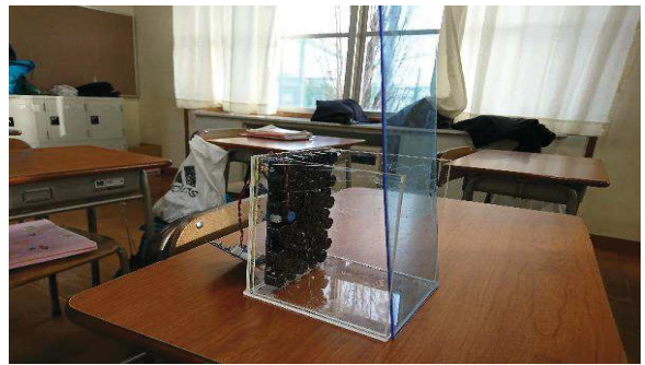
反射板を付けた超指向性超音波スピーカー
