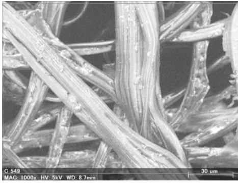
図 6. 電子顕微鏡(×1000)で見たトビケラシルク (実験室で造らせたトビケラシルク)
