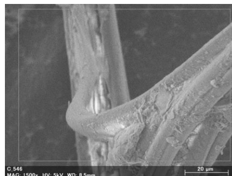
図 5. 電子顕微鏡(×1000)で見たトビケラシルク (賀茂川で採取したトビケラシルク 分岐部分)
