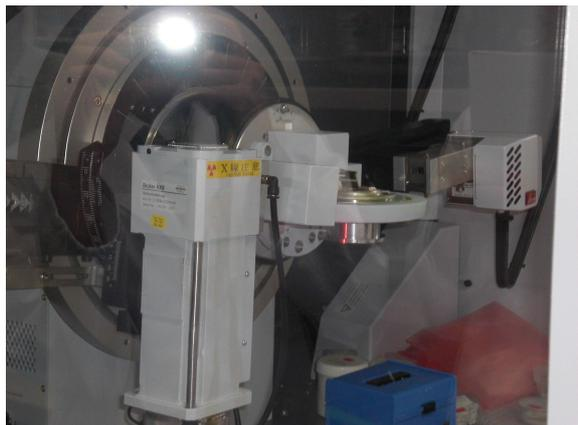
写真 2 粉末 X 線回折装置
