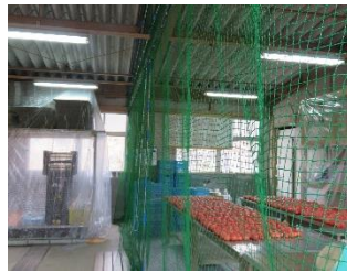
鳥類の進入防止ネット
