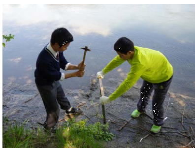
ボーリングコア採取の様子
