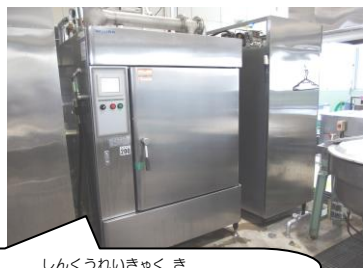
これが真空冷却機。おお大きな冷蔵庫のようです。
